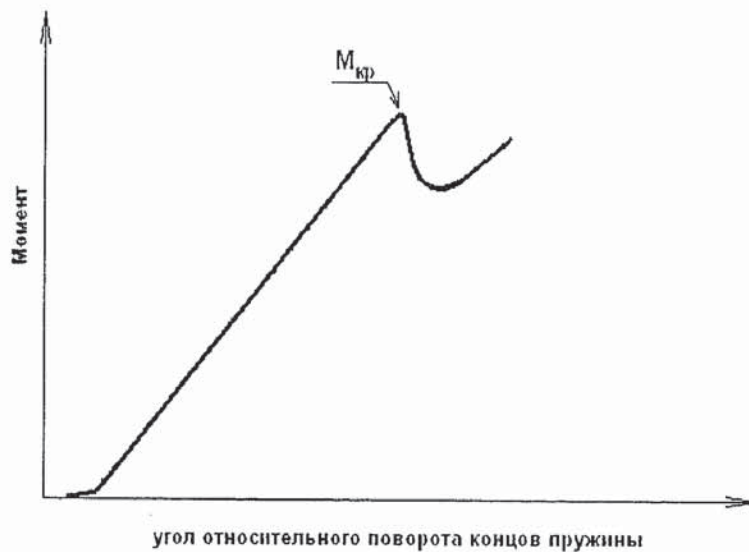
Рис. 3. Типовая упругая характеристика кручения пружины, изогнутой в полуокружность
