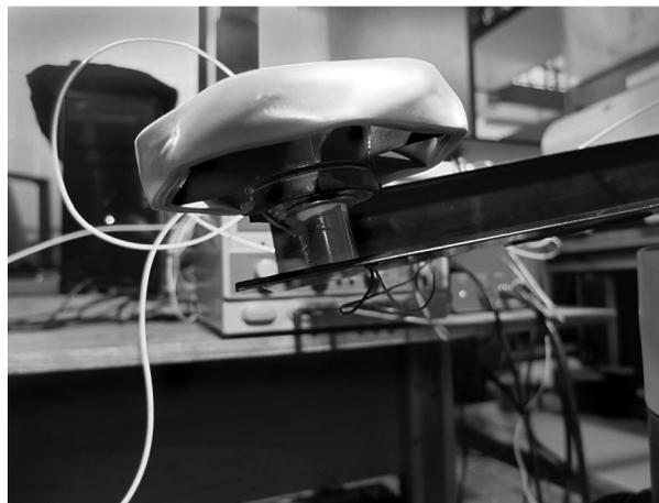
Рис. 3. Крепление подпружиненного ротора к крепежной панели
