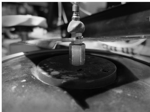
Рис. 4. Фиксация крепежной панели латунной переходной втулкой, установка контрольно-измерительного датчика Kistler на пластилин
