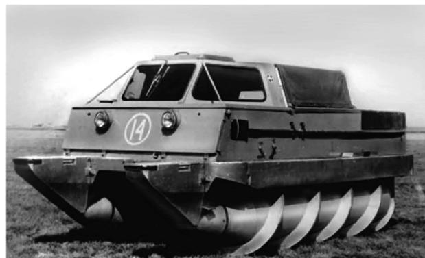
Рис. 1. Роторно-винтовые движители с различной высотой и углом наклона витков
