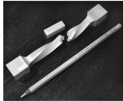
Рис. 1. Опытный образец, скрученный на испытательной машине INSTRON, и его срединная часть, используемая для численного моделирования
