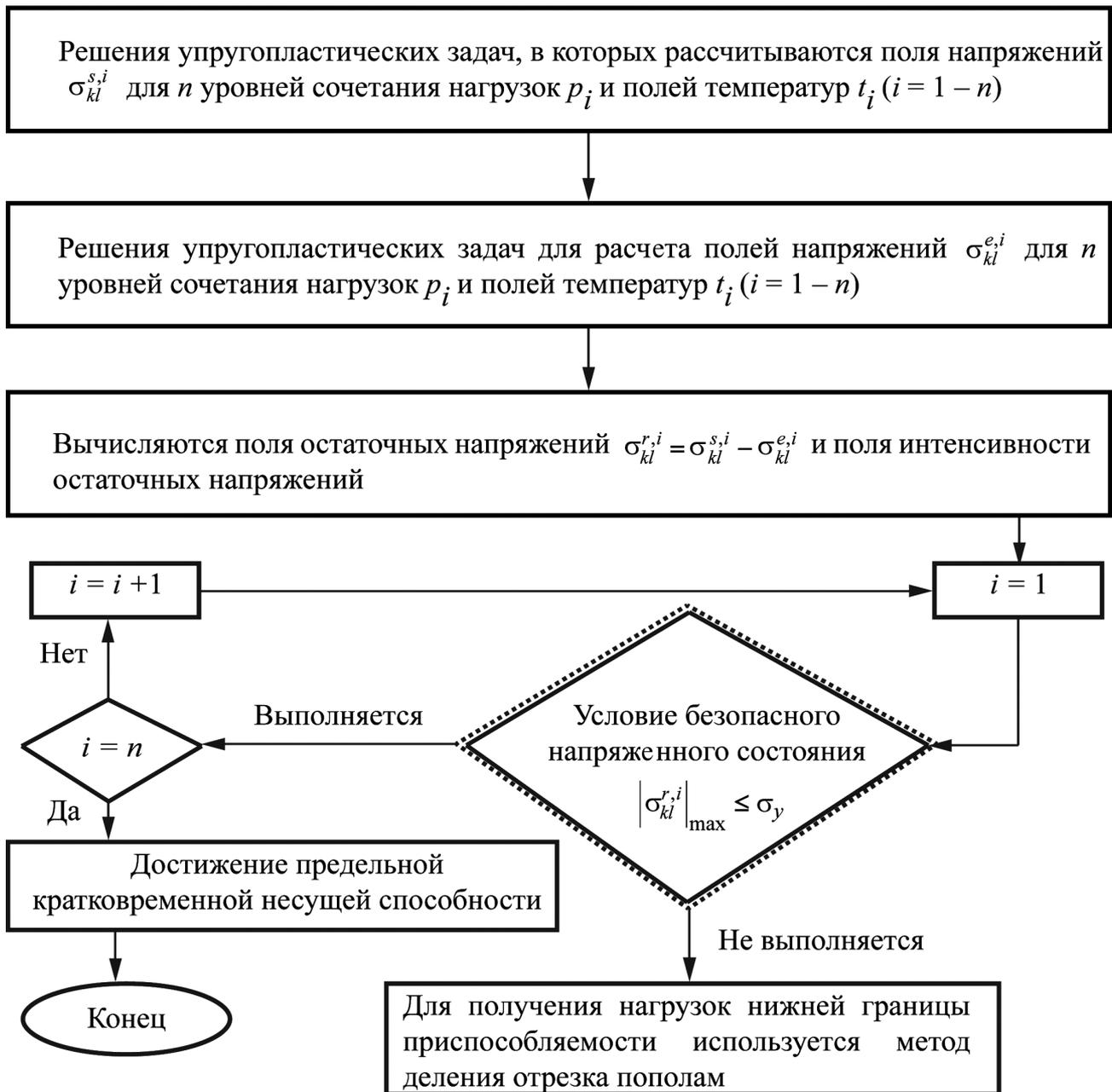
Рис. 1. Схема определения нагрузок нижней границы приспособляемости с помощью МКЭ
