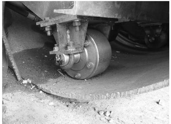
Рис. 11. Опорный ролик вибровального вальца катка, смещенный к торцу обечайки (не приводной)
