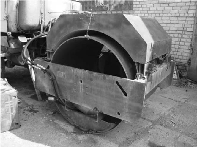
Рис. 10. Каток СД-802 с установленным на нем вальцом катка КВ-03
