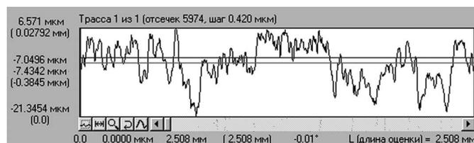
Рис. 3. Профилограмма поверхности образца.
