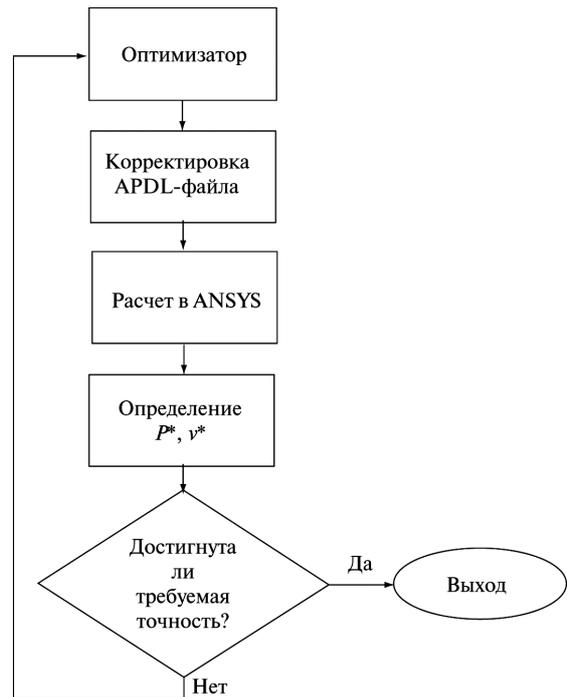
Рис. 2. Блок-схема процедуры решения в PSE/MACROS
