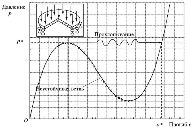
Рис. 1. Упругая характеристика микроактюатора
