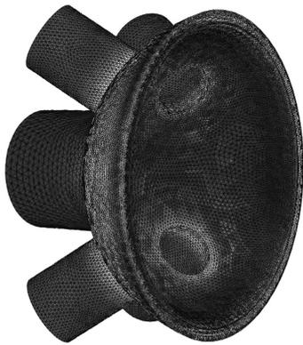
Рис. 1. Элемент КВД и конечно-элементная сетка, сгенерированная для расчетов НДС
