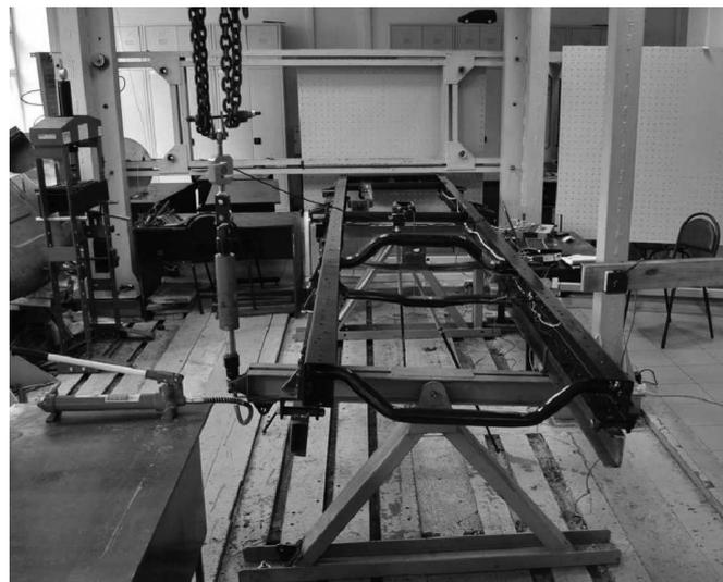
Рис. 1. Установка рамы с фальшрессорами на стенде для испытания в режиме кручения
