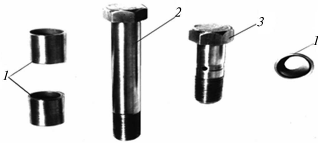
Рис. 4. Детали шарниров грядила культиватора КРХ- 4:
