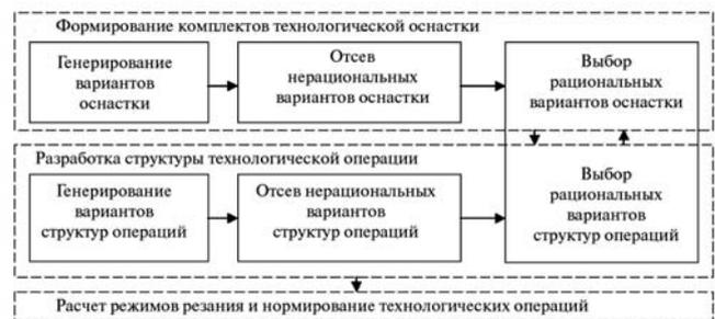
*Рисунок.* Фрагмент структурной модели автоматизированной подсистемы проектирования технологических операций для оборудования сверлильной группы
