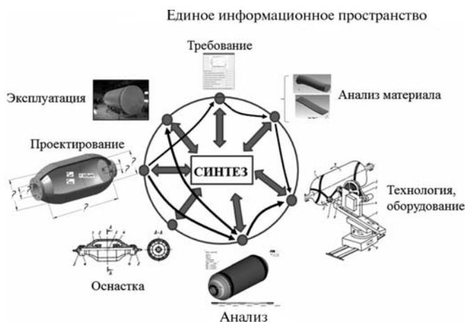
Рис. 1. Упрощенный жизненный цикл баллона давления, изготовленного из композиционного материала методом намотки
