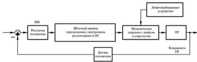
Рис. 2. Следящий привод с дополнительным контуром управления
