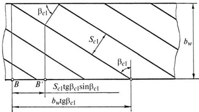
Рис. 4. Развертка сечения боковой поверхности зубьев цилиндра радиусом  $r_{c1}$
