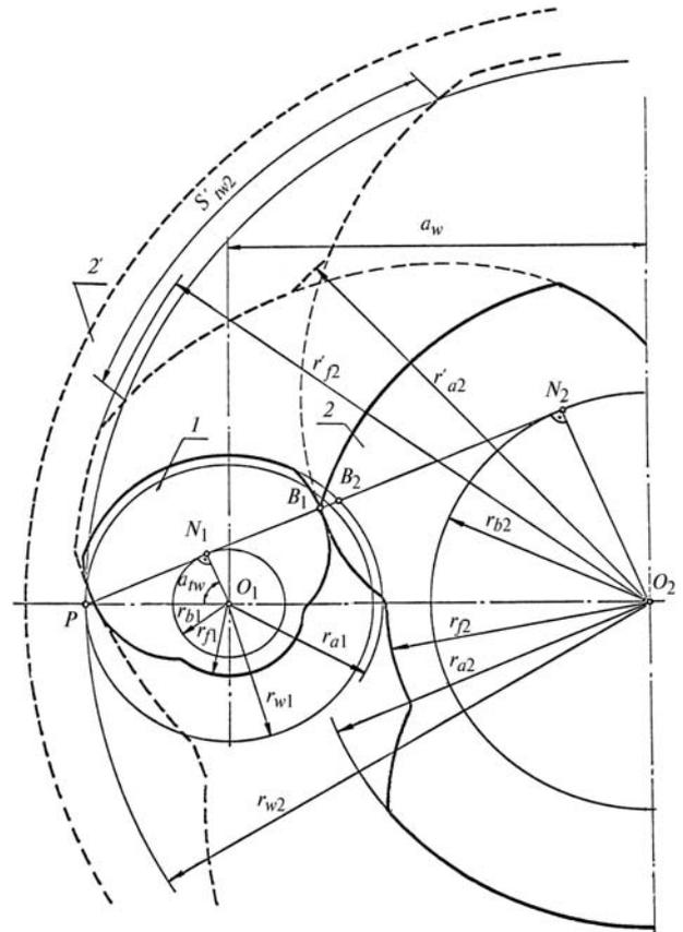
Рис. 3. Основное и дополнительное зацепления инверсной передачи с внешними зубьями при одинаковых направлениях наклона зубьев
