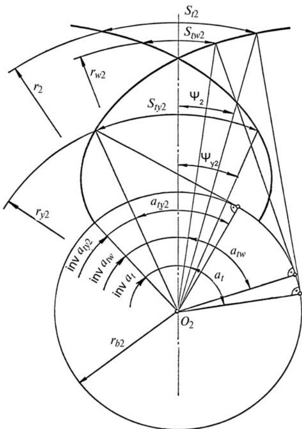
Рис. 2. Схема толщины зуба по делительной и произвольным окружностям
