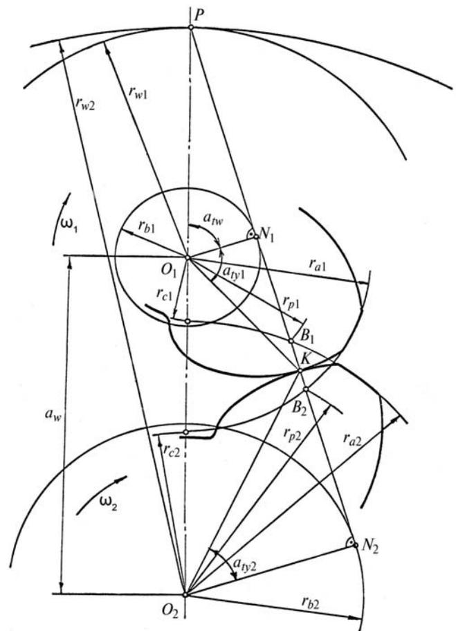
Рис. 1. Схема внешнего эвольвентного инверсного зацепления при одинаковых направлениях наклона зубьев
