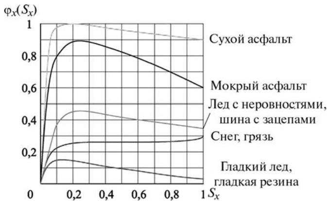
Рис. 1.  $\varphi_x(S_x)$ -диаграммы для различных поверхностей в тормозном режиме
