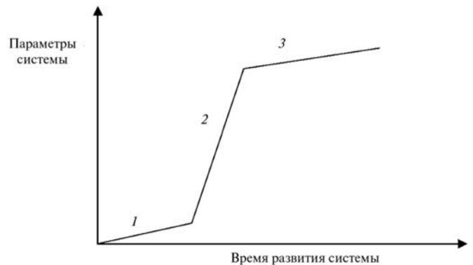
Рис. 2. Процесс совершенствования отдельного технического средства в рамках данного принципа действия:
