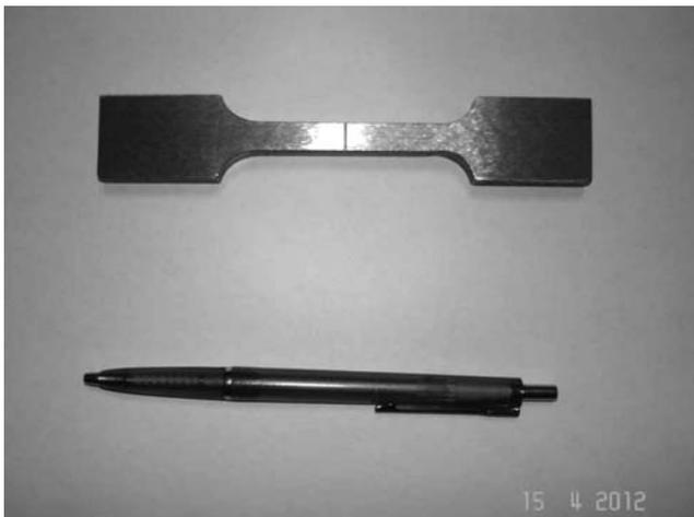
Рис. 1. Опытный образец с риской
