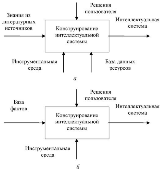
Рис. 8. Функциональные схемы конструирования интеллектуальных систем
