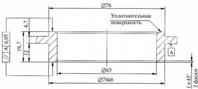
Рис. 1. Опытная деталь имитирующая «седло» клапана низкого давления DN 65
