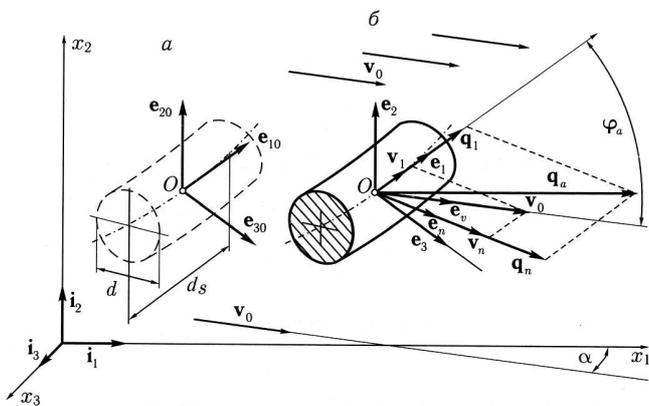
Рис. 1. Аэродинамические силы, действующие на элемент стержня в деформированном состоянии со стороны потока воздуха
