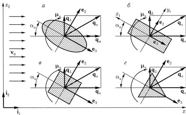
Рис. 2. Поперечные сечения стержней плохообтекаемого профиля с подъемными силами и аэродинамическими моментами
