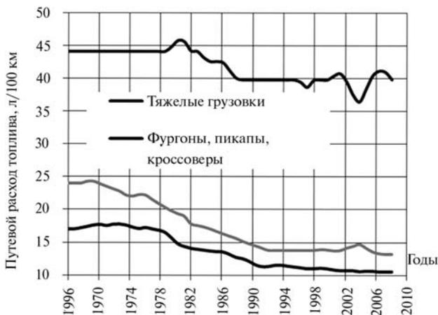
Рис. 2. Средние значения путевого расхода топлива различными типами транспортных средств
