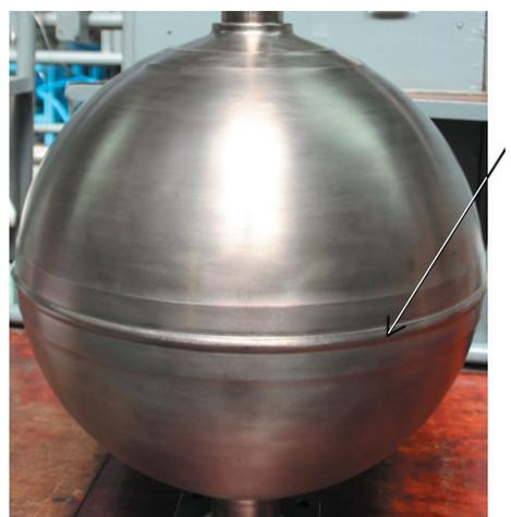
Рис. 1. Внешний вид титановой емкости, свариваемой из полусфер ЭЛС
