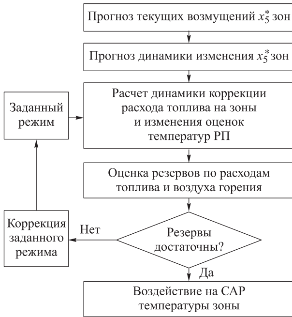
Рис. 3. Формирование упреждающего воздействия по расходу топлива и прогноза оценки температуры РП от эталонной модели
