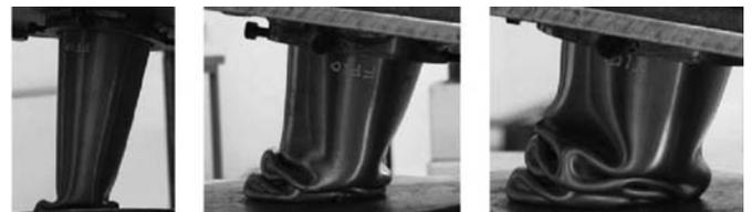
Рис. 4. Процесс деформирования испытуемого образца
