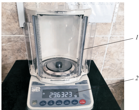
Рис. 3. Фрагмент измерения массы образца на аналитических весах HR-150AR: 1 — платформа с образцом; 2 — экран с результатами измерения
