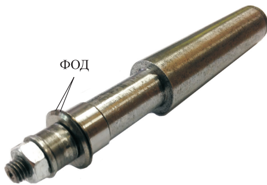
Рис. 5. Опытный образец сборного инструмента с осевым колебанием формообразующих профилей для планетарного накатывания резьбы
