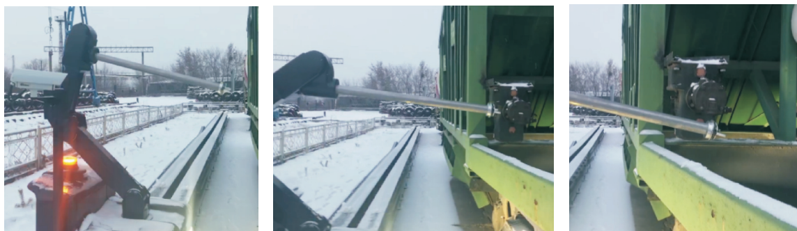
Рис. 11. Фрагменты роботизированного отпуска тормозов вагона типа хоппер: а — продольное перемещение РТК вдоль ПС; б — идентификация воздухораспределителя, требуемого вагона, начало процесса работы МР; в — воздействие на клапан воздухораспределителя
