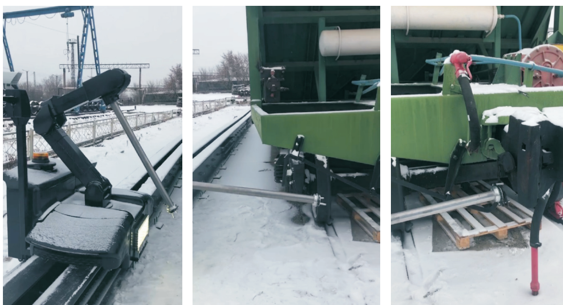
Рис. 11. Фрагменты роботизированного отпуска тормозов вагона типа хоппер: а — продольное перемещение РТК вдоль ПС; б — идентификация воздухораспределителя, требуемого вагона, начало процесса работы МР; в — воздействие на клапан воздухораспределителя
