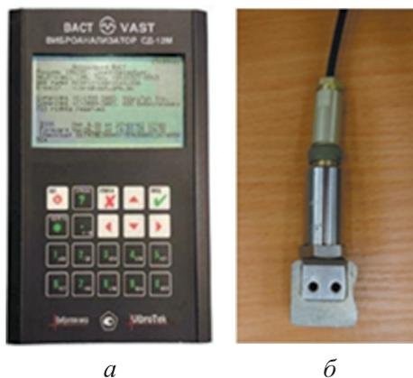
Рис. 3. Внешний вид вибронализатора ВАСТ СД-12М (а) и акселерометра АР28И (б)
