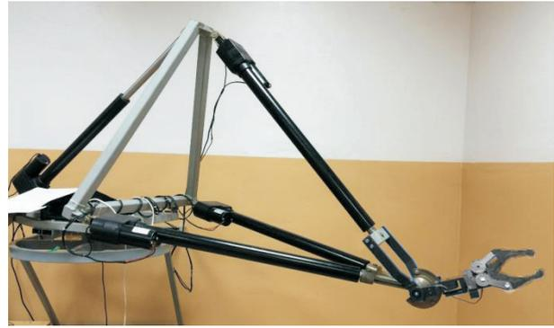
Рис. 4. Внешний вид экспериментального образца манипулятора-трипода с актуаторами SKF САНВ-21
