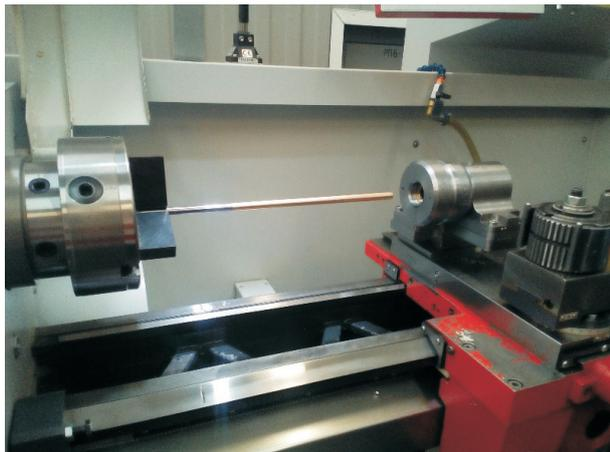
Рис. 4. Внешний вид приспособления и комплекта оснастки для раскатки на токарном станке
