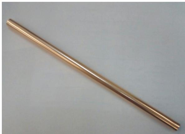
Рис. 5. Внешний вид заготовок (трубочек) после раскатки
