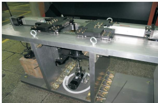
Рис. 6. Внешний вид установки предварительного гофрирования заготовок для ГВС
