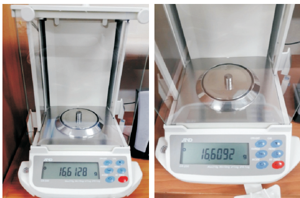
Рис. 7. Результаты взвешивания ролика на аналитических весах до (а) и после (б) испытаний СОЖ-1
