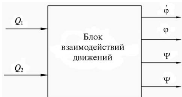
Рис. 6. Представление блока взаимодействия движений в виде шестиполосника: входы Q_1, Q_2 — обобщенные силы; выходы — углы и скорости перемещений первого и второго звеньев \varphi, \psi, \dot{\varphi}, \dot{\psi}
