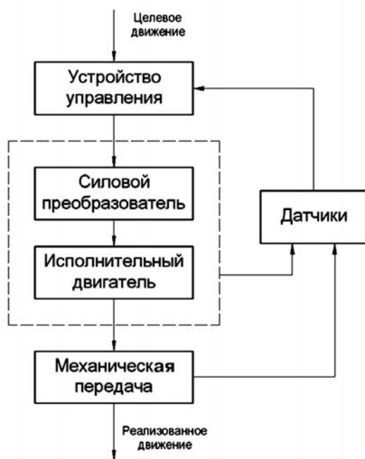
Рис. 1. Структура однокомпонентного мехатронного модуля
