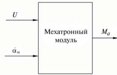
Рис. 3. Представление мехатронного модуля в виде трехполюсника
