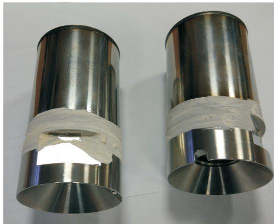
Рис. 6. Проведение испытания на герметичность сварных швов корпуса датчика
