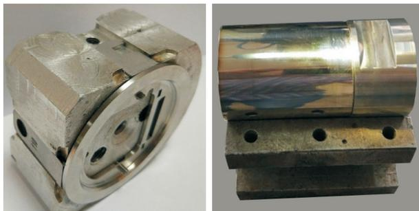
Рис. 4. Размещение деталей пьезоэлектрического акселерометра РеА12 в сварочной оснастке:
