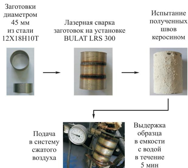
Рис. 3. Технологическая схема пневматического испытания образцов
