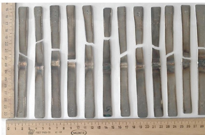
Рис. 3. Внешний вид плоских образцов после испытания на статическое растяжение
