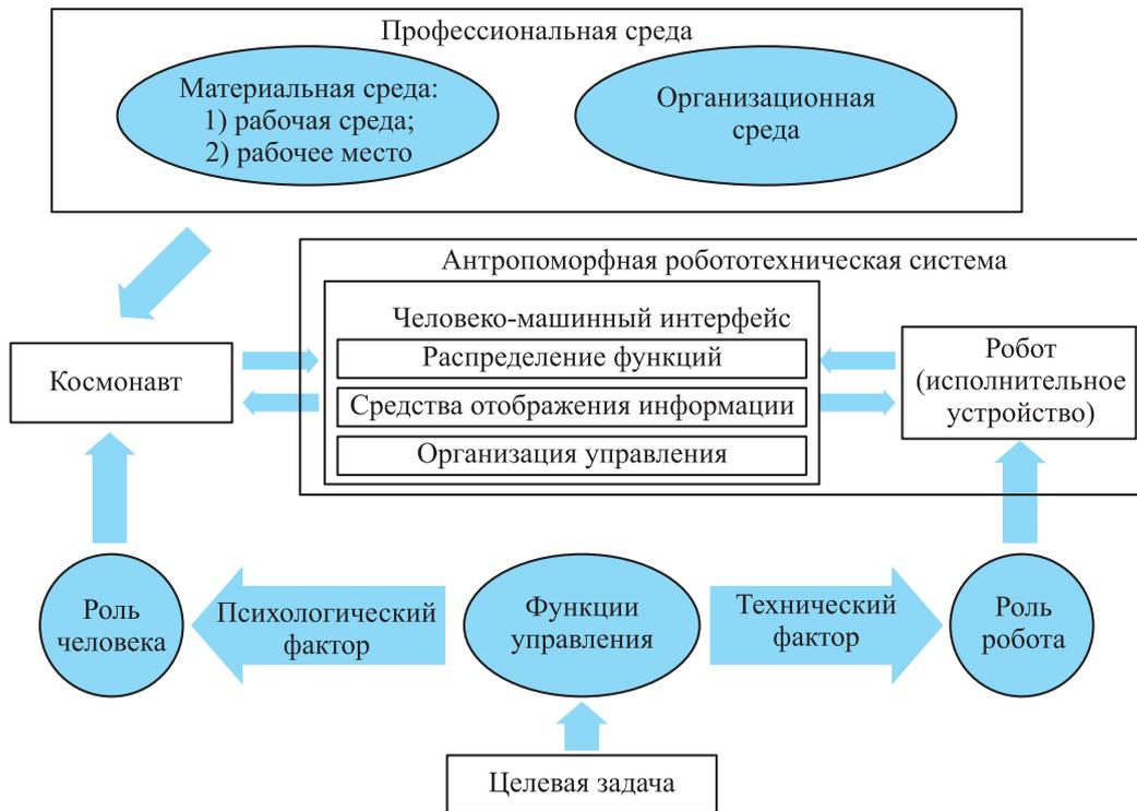
Рис. 1. Структура эргатической системы космонавт — робот — среда
