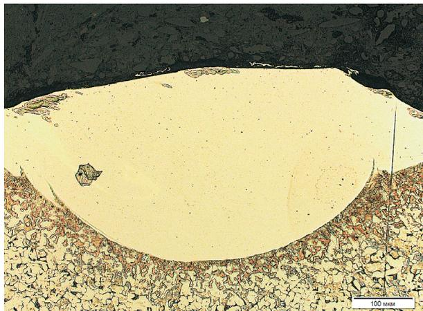
Рис. 6. Микроструктура валика, получаемого методом импульсного СЛП
