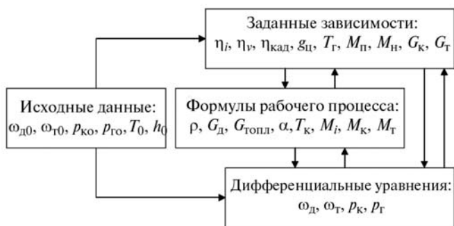
Рис. 2. Структура динамической модели комбинированного дизеля
