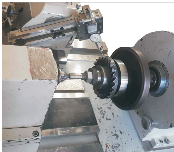
Рис. 3. Измерение высоты огранки на Контактномере БВ-5028
