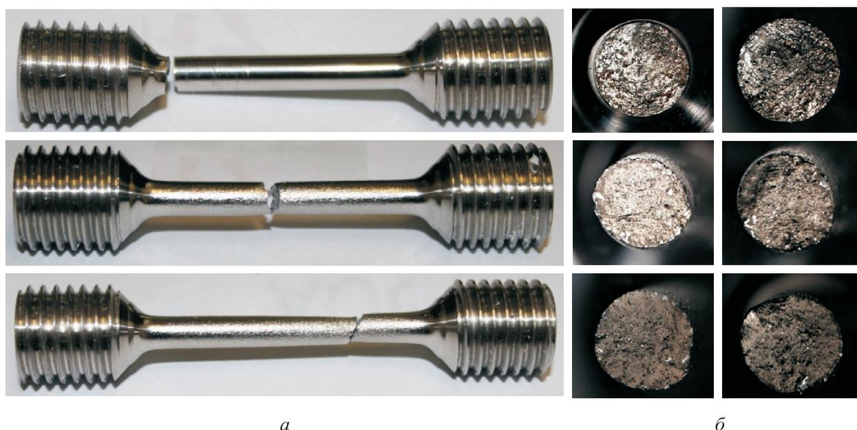
Рис. 1. Фотографии общего вида (а) и места разрыва (б) испытанных образцов
