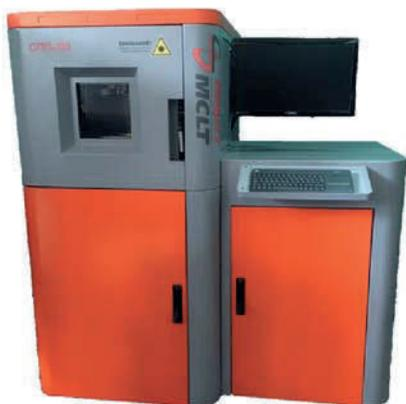
Рис. 1. Внешний вид установки СЛП-110
