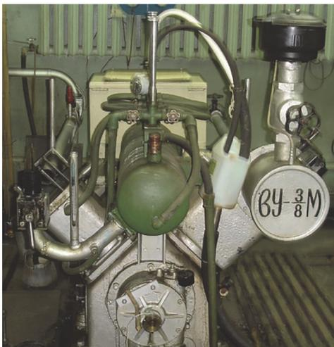
Рис. 1. Общий вид компрессора ВУ-3/8М
