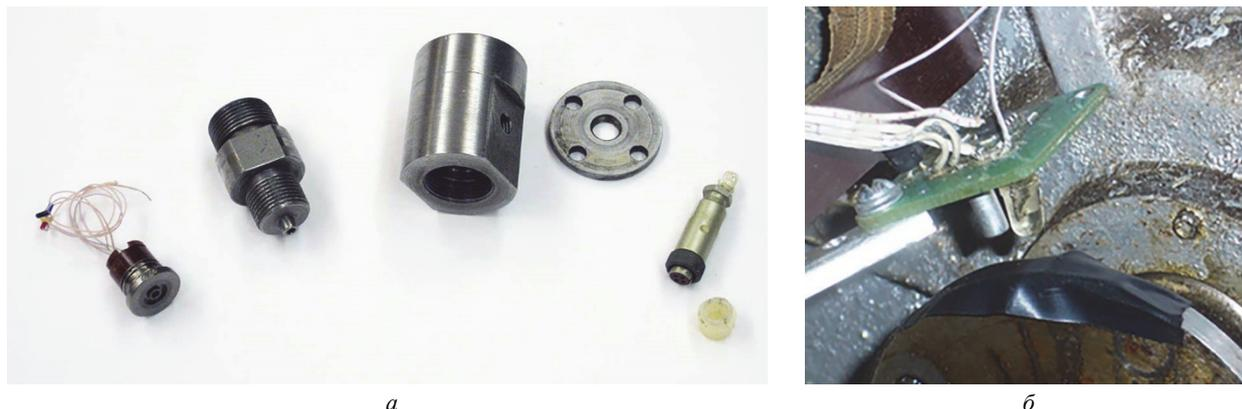
Рис. 6. Внешний вид элементов датчика давления (а) и отметчика оборотов (б)
