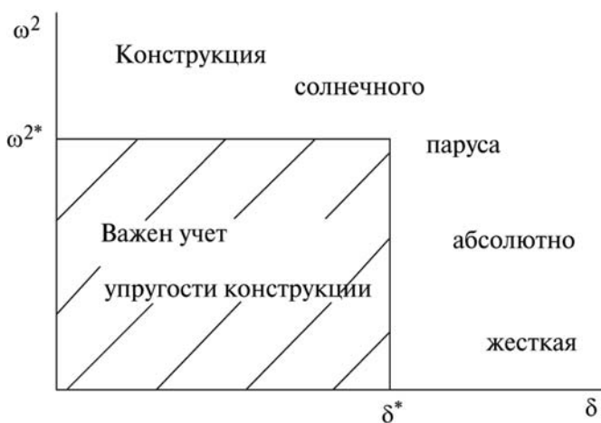
Рис. 1. Диаграмма определения механических характеристик солнечного паруса
