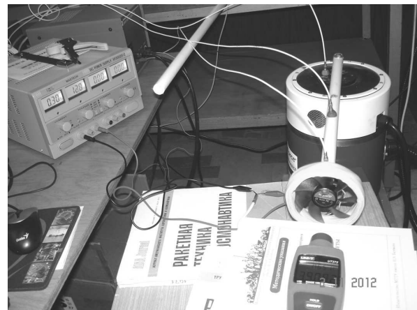
Рис. 4. Лабораторная установка для частотных (резонансных) испытаний ротора на несимметричной балочной опоре
