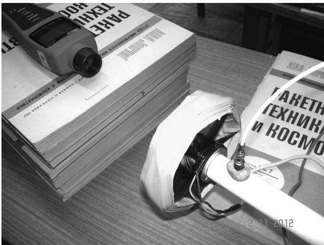
Рис. 5. Крепление ротора к полипропиленовой балке. Установка лазерного бесконтактного тахометра. Установка датчика ускорений рядом с ротором
