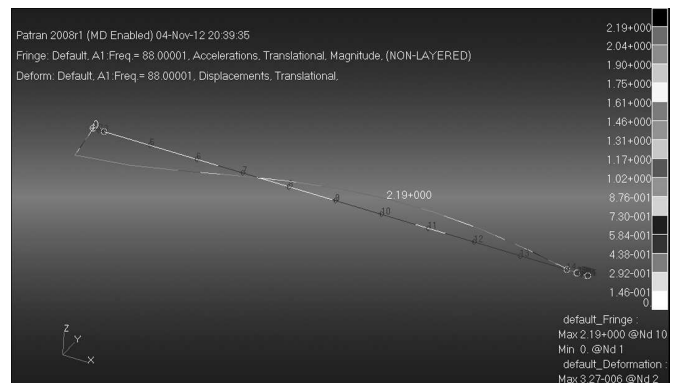
Рис. 9. Форма колебаний нижнего тона пары взаимодействующих тонов ротора при моделировании его кинематического возбуждения в среде MSC.Nastran.Rotordynamics
