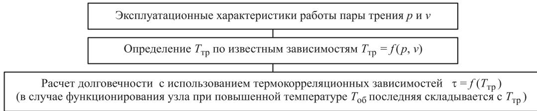
Рис. 2. Алгоритм расчета долговечности пары трения с композиционными ТСП, содержащими связующие вещества
