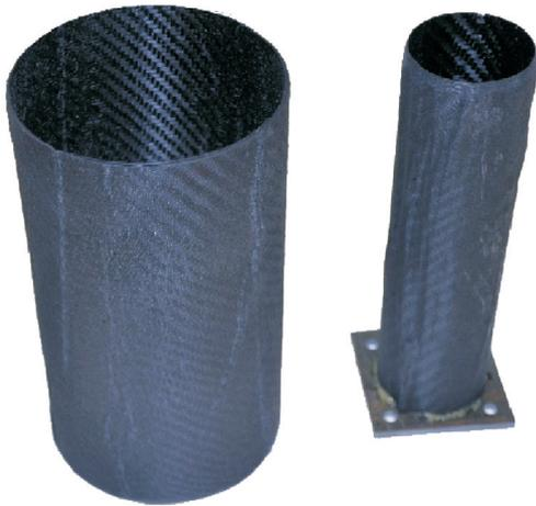
Рис. 2. Образцы углепластиковых ЭПЭ
