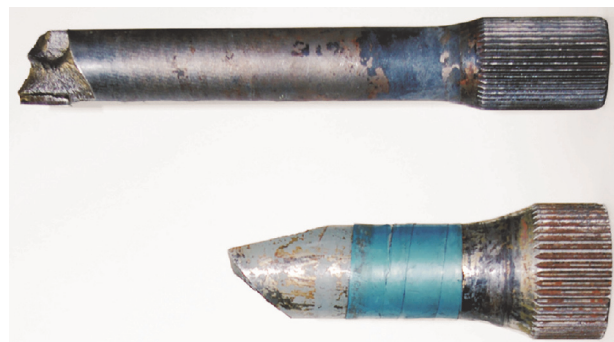
Рис. 1. Разрушение ТВ по цилиндрической части
