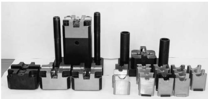
Рис. 2. Экспериментальный штамп для гибки
