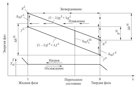
*Рис. 3.* Диаграмма состояний базисных структурных объектов идеализированной двухкомпонентной металлической системы
