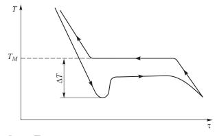
Рис. 2. Переохлаждение расплава при затвердевании
