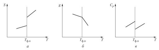
*Рис. 1.* Изменение энтропии S(a), химического потенциала g(b) и удельной теплоемкости  $C_p(b)$  при температуре фазового перехода  $T_{\phi,\Pi}[1]$
