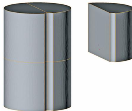
Рис. 6. Образцы для моделирования опыта на осадку
